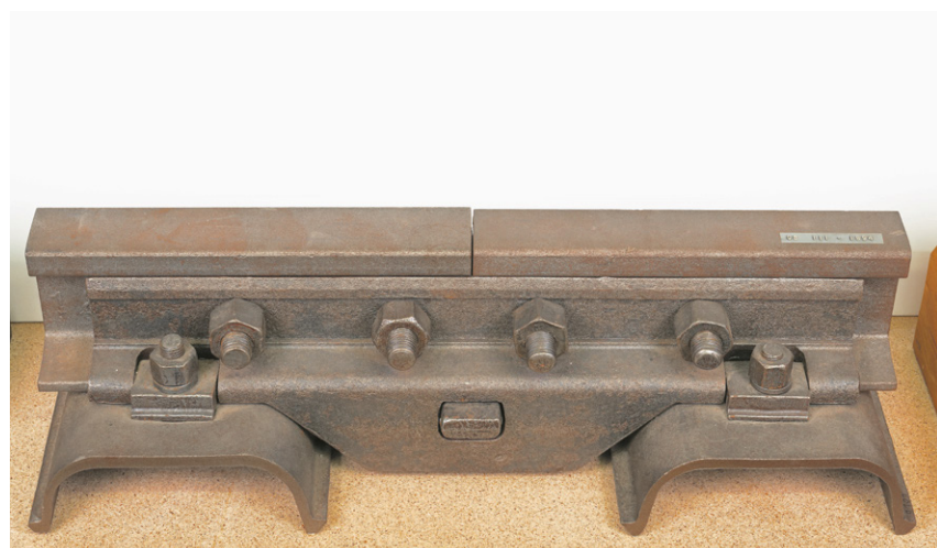
Ein Schienenstoss der Gotthardbahn 1893. Die ersten Schienen bestanden aus Schweisseisen. FOTO: FACHSTELLE SBB, NICK BRÄNDLI
